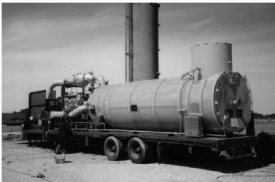
شکل شماره (۴) - نمونه‌ای از تجهیزات مکانیکی تخلیه بخار
