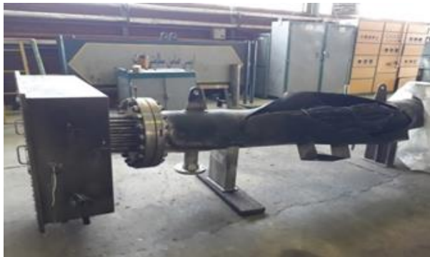
مبدل حرارتی منفجر شده
