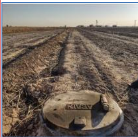
شکل ۴- پرتاب درب محفظه ارسال توپک به فاصله ۲۵۰ متری
