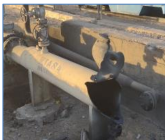
شکل ۲- محفظه ارسال توپک منفجر شده (ایستگاه A)
